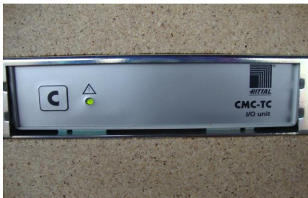
Figura 112 - Unidade I/O Fonte: Autor
