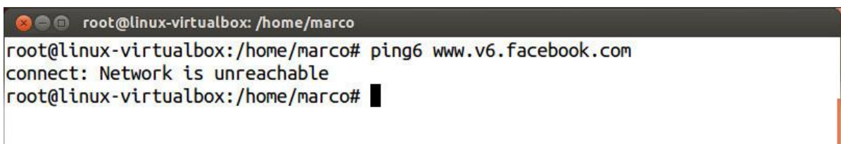
Figura 75 - Internet IPv6 inacessível após bloqueio no firewall. Fonte: Do Autor.
