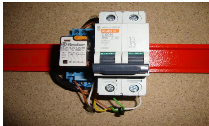
Figura 109- Relé e disjuntor Fonte: Autor
